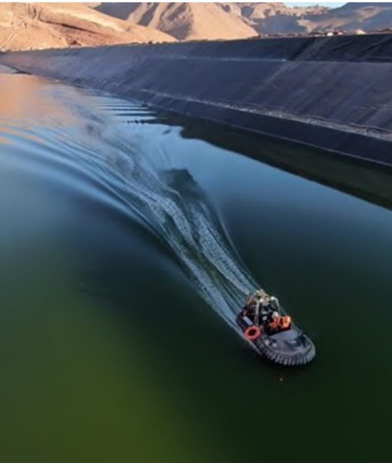
Refiriéndose específicamente en el Trabajo sobre relaves, contamos con la ayuda de aerodeslizadores (Hovercraft), provistos por British Hovercraft Company, los cuales son modificados especialmente para un funcionamiento a altas alturas y arduas condiciones del mundo minero.
